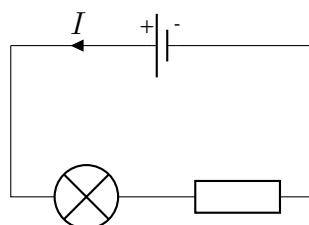
**Principe de conservation de l'énergie :** Dans un circuit électrique, l'énergie fournie par le générateur est égal à la somme des énergies reçues par les récepteurs
