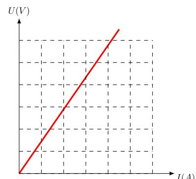
Dans le cas du conducteur ohmique, la caractéristique est une droite passant par l'origine du repère. La tension est donc proportionnelle à l'intensité. La résistance R correspond au coefficient directeur de la droite.
