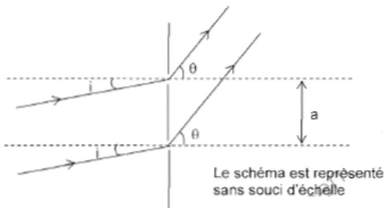
3. Calculer dans le spectre d'ordre 1, les angles  $\theta_1$  et  $\theta_2$  pour les radiations de longueur d'onde  $\lambda_1$  et  $\lambda_2$ , le réseau étant éclairé sous incidence normale. En déduire l'écart angulaire entre les deux radiations.
